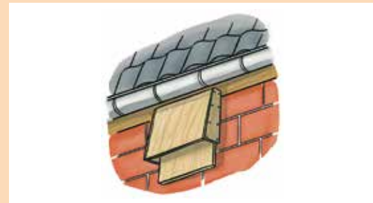
Fledermausbrett unter Dachüberstand
