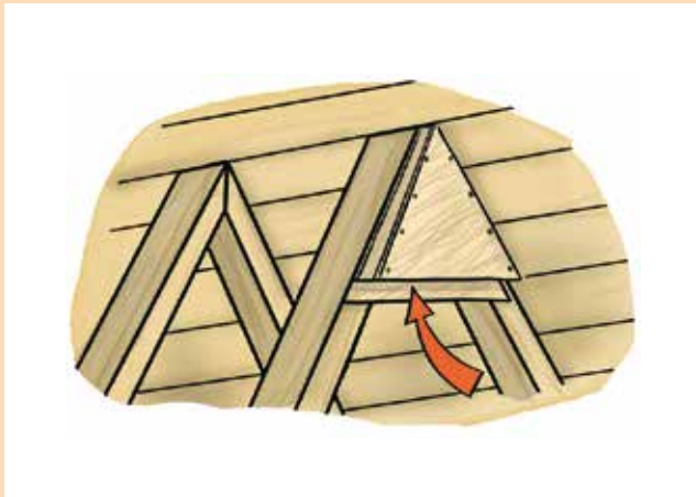
Spaltenquartier im Sparrendach
