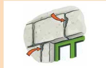
Spalten und Ritzen im Mauerwerk
