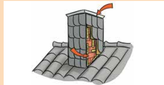
Ein Schornstein kann noch nachträglich verkleidet und als Fledermausquartier nutzbar gemacht werden.
