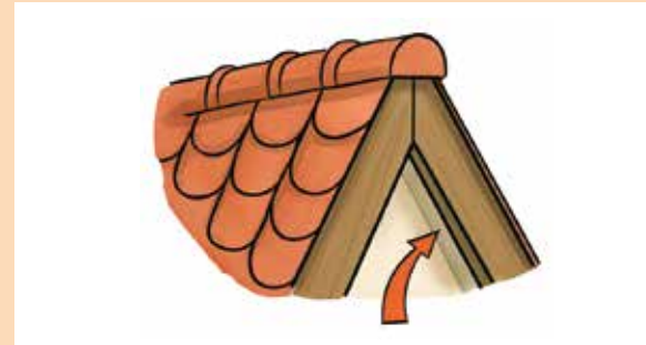
Einflugmöglichkeit über offenen Dachüberstand
